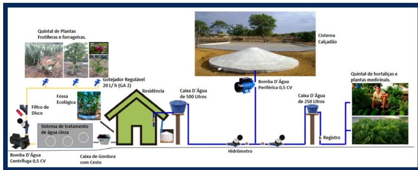
Figura 8 – Ilustração de sistemas de abastecimento de água de uso doméstico não nobre e de reúso de água da ASA.
