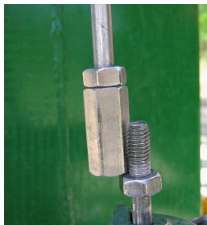
Varetas e porcas feitas de aço inoxidável. A rosca é rolada e não cortada, para evitar pontos de fratura
